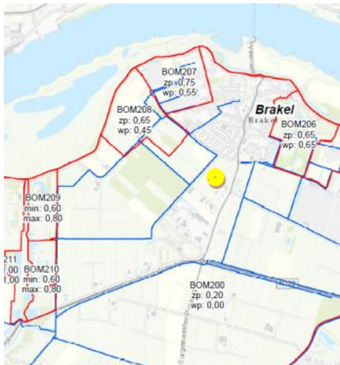
Figuur 2 Peilbesluit Bommelerwaard: vastgesteld door AB WSRL 26-04-2018 Peilvakken in rood aangeduid / A-watgangen in blauw / gele stip is locatie
